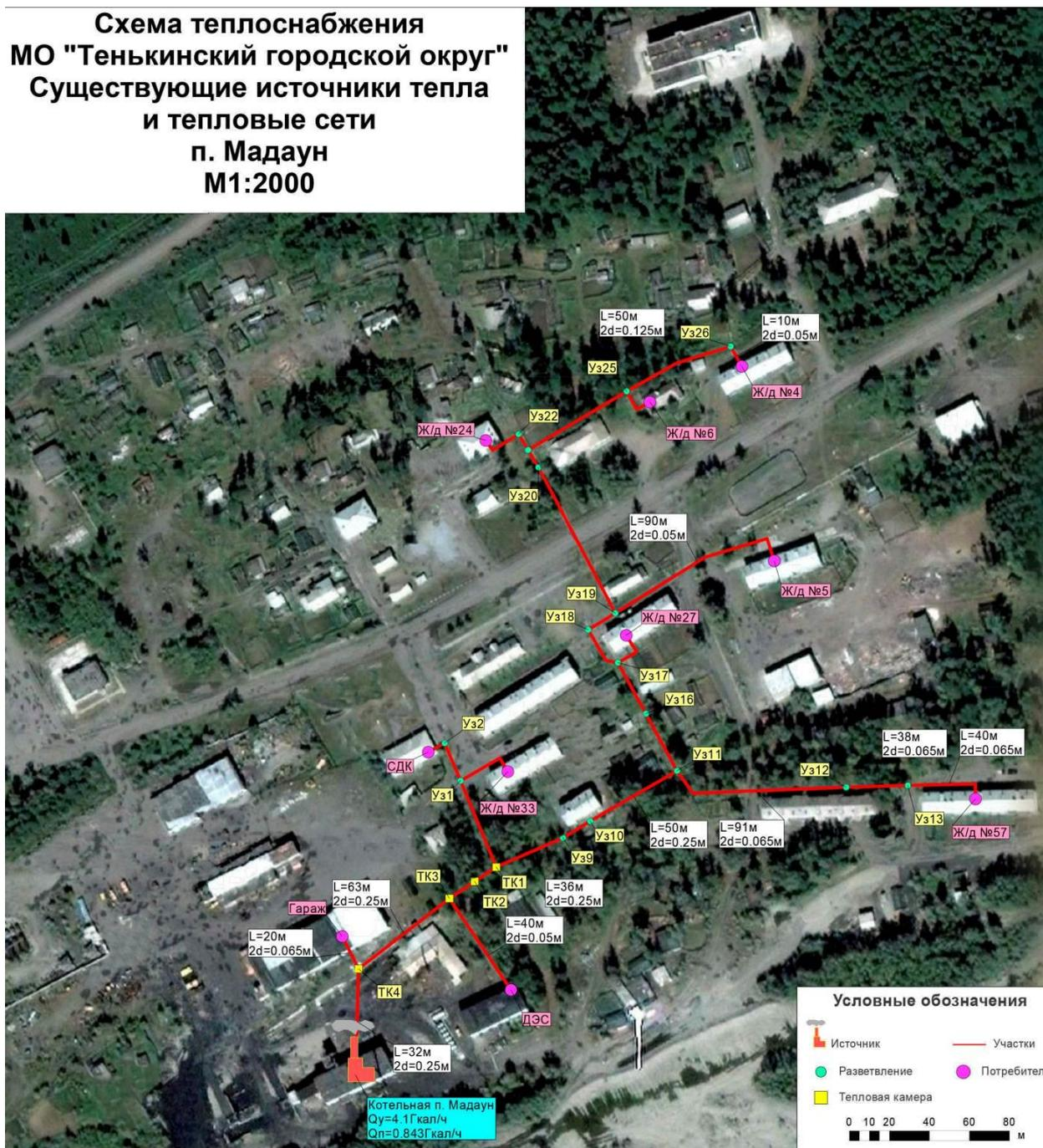
Рисунок 1.3.1 – Схема тепловых сетей п. Мадаун
