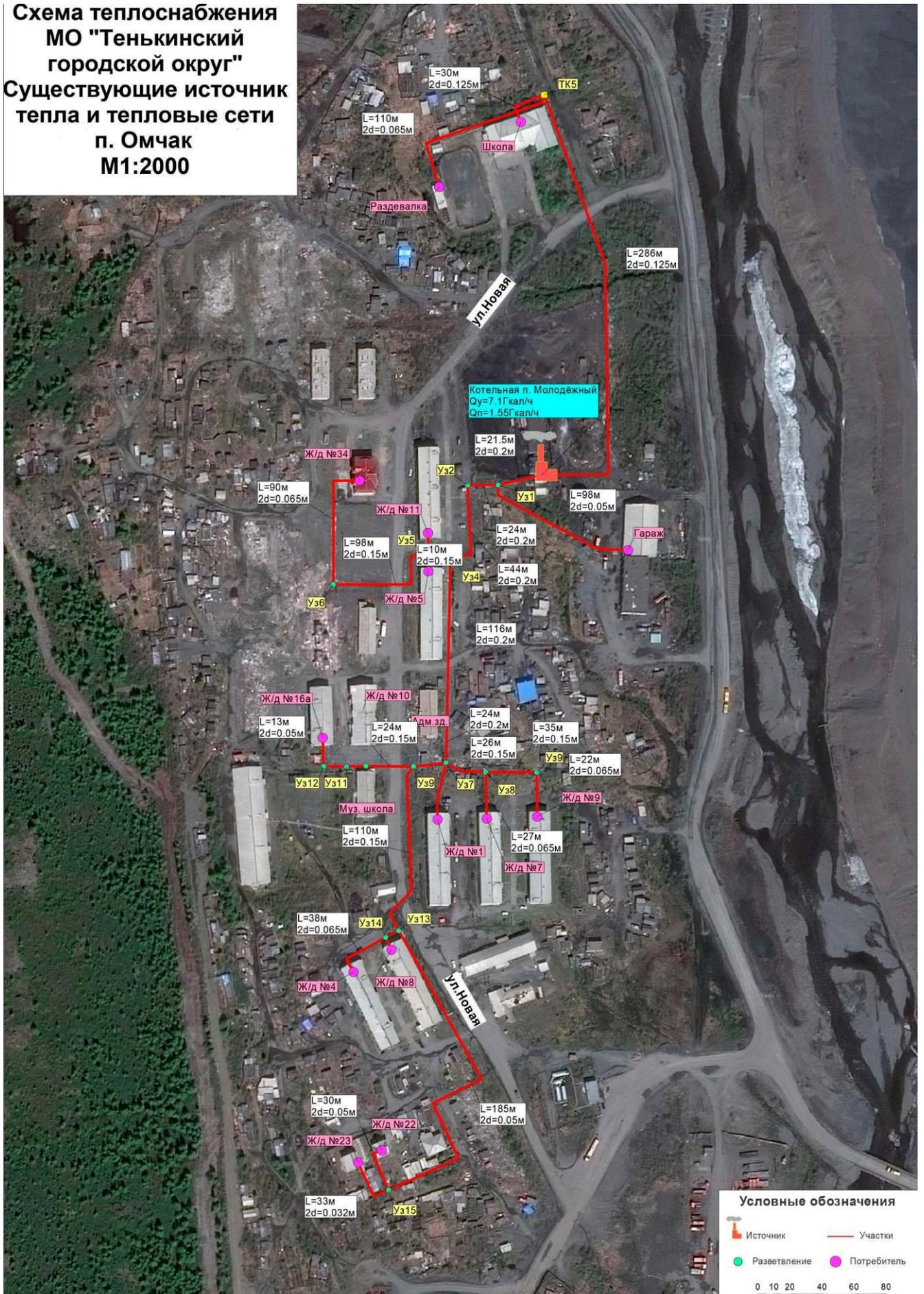
Рисунок 1.3.2 – Схема тепловых сетей п. Омчак
