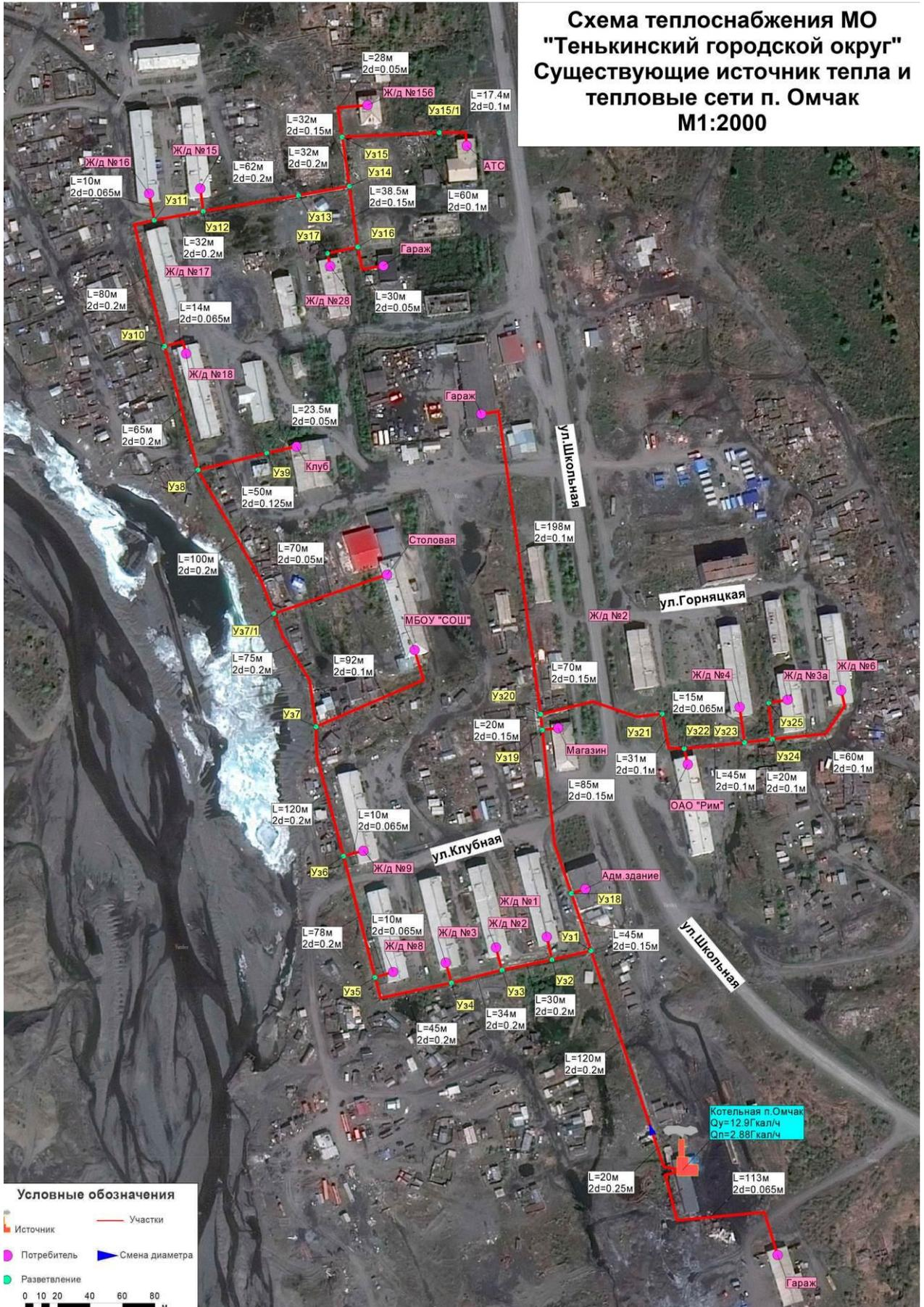
Рисунок 1.3.1 – Схема тепловых сетей п. Омчак
