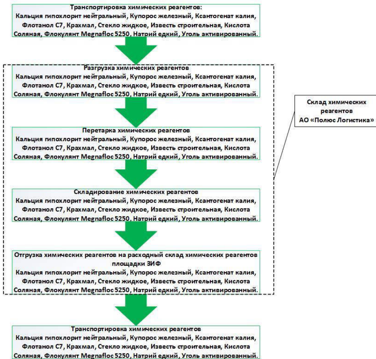
Рисунок 2 - Схема основных технологических потоков химических реагентов
