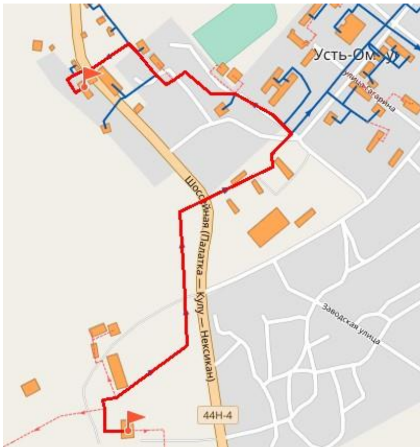
Рис. 3.12. Путь движения теплоносителя от источника до конечного потребителя Лесной пер. 7 по состоянию 2022 года схемы теплоснабжения
